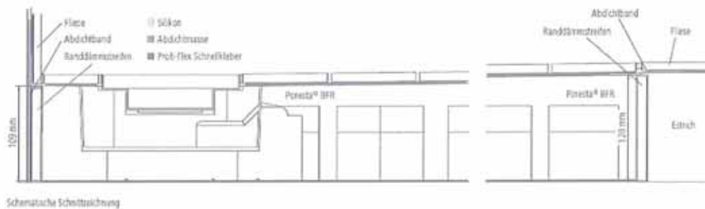
Abbildung 6: Schematische Schnittzeichnung PORESTA BFR
